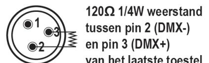
aardlus ontstaan en het toestel werkt willekeurig. Controleer de kabels d.m.v. een ohmmeter om de polariteit te controleren en te waarborgen dat de pins niet op aarde aangesloten of met elkaar kortgesloten zijn.
