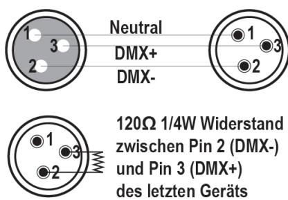
Bei längeren Kabelwegen ist es empfehlenswert, einen Endwiderstand zwischen Pin 2 und 3 zu löten, um Signalfehler zu vermeiden.
